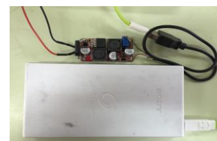
圖十七 變電、儲電裝置
