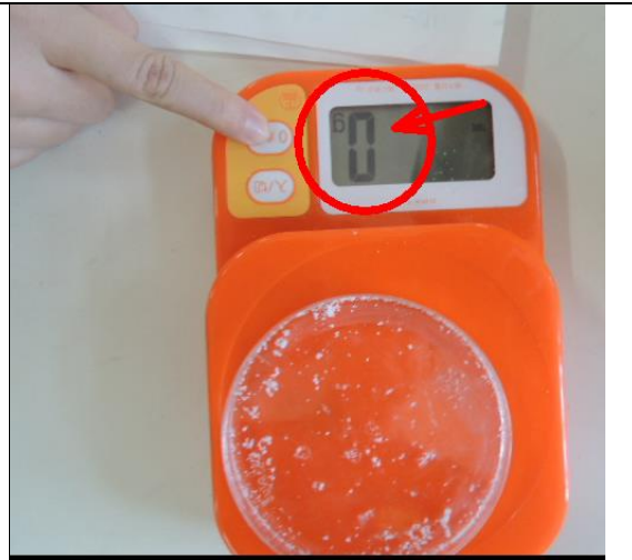
圖二：濃度實驗時一定要歸零，以利作調配出 5%、10%、20%濃度液體
