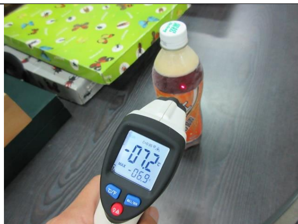
加鹽沙士過冷過程測溫情形
