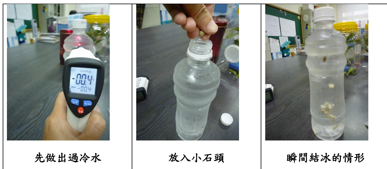
圖 4-18 除了鹽巴外，所有投入的模擬結晶核，皆可以讓過冷水瞬間結冰
