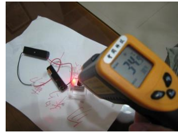
(14) 電線連接處 34.9 度
