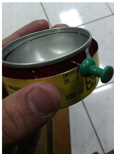
4.在邊緣鑽上燃燒孔。
