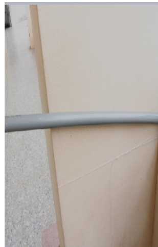
固定水管使鋼珠自由落下
