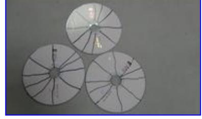
在正版及複製光碟片的印刷面畫放射狀直線
