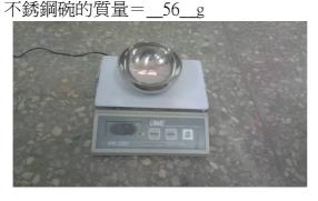
不銹鋼碗的總體積(包含中央空氣部分)=\_249.5\_mL 不銹鋼碗恰好下沉時量筒中剩餘水的體積=\_306.0\_mL
