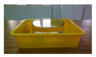
2.將空的塑膠瓶慢慢地放入裝滿水的透明水缸中,測量溢出水的體積,即爲此塑 膠瓶在水面下的體積,並且記錄下來。
