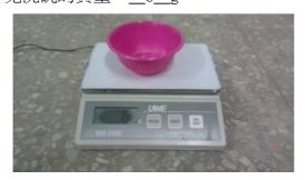
免洗碗的總體積(包含中央空氣部分)=\_254.5\_mL實驗發現免洗碗在倒滿水的時候不會下沉,這是爲什麼呢?免洗碗在倒滿水時量筒中剩餘水的體積=\_257.0\_mL
