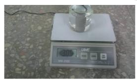
沉體下降到燒杯的底部時電子秤的讀數=\_\_316\_\_g=(280+35)g
