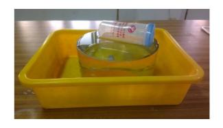
3.依序在塑膠瓶中裝入 60 cm³、120 cm³、180 cm³、240 cm³、300 cm³的水,也是將此塑膠瓶慢慢地放入裝滿水的透明水缸中,測量溢出水的體積,即爲此塑膠瓶在水面下的體積,並且記錄下來。
