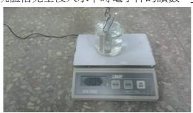
沉體下降到燒杯的底部時電子秤的讀數=\_\_350\_\_g=(280+70)g
