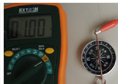
電流 - 1.0A 偏移角度 22度
