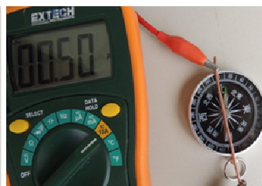
電流 - 0.5A 偏移角度 12度
