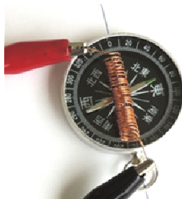
線圈 30 圈 偏轉角 76 度
