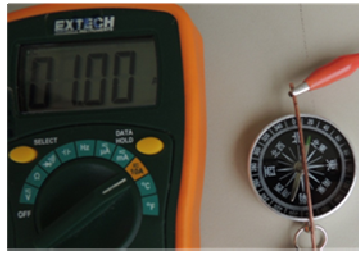
電流 - 1A 偏移角度 22度 (1.6mm 線徑)
