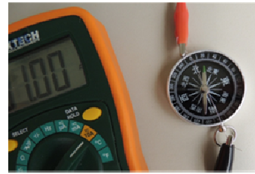
電流 - 1A 偏移角度 22度 0.2mm 線徑)
