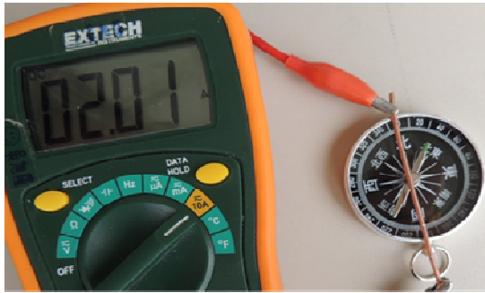
電流 - 2.0A 偏移角度 34 度
