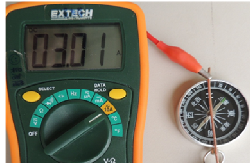
電流 - 3.0A 偏移角度 42 度
