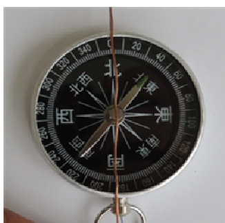
線圈 0 圈 偏轉角 40 度
