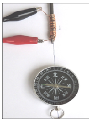
螺旋線圈加入鐵釘後 指北針移動 70 度
