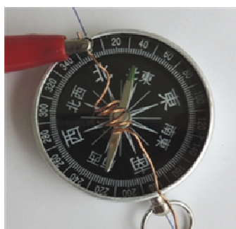
線圈 3 圈 偏轉角 40 度
