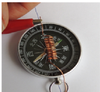
線圈 15 圈 偏轉角 58 度
