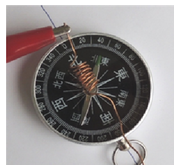
線圈 7 圈 偏轉角 44 度
