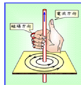
圖 4-1 單導線電流所產生的同心圓磁場
