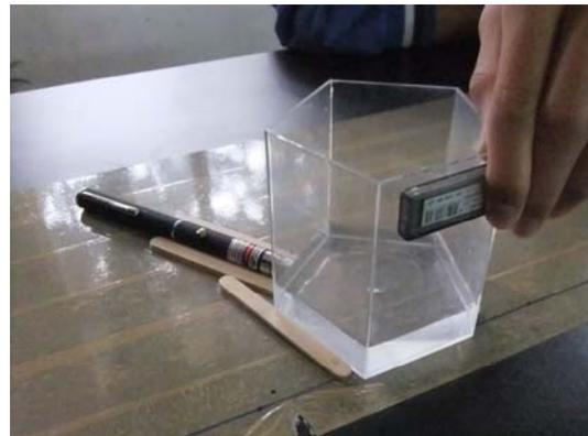
實驗裝置如圖一，用皮尺拉 5 公尺的長度，一端固定在牆壁上，另一端在實驗桌上標上記號，取好幾點之後，將這些點連成直線，以確認塑膠盒與牆面平行。用木條將塑膠盒外圍固定，也將雷射光的外圍固定，以減少因為塑膠盒或雷射光的移動而造成的誤差。
