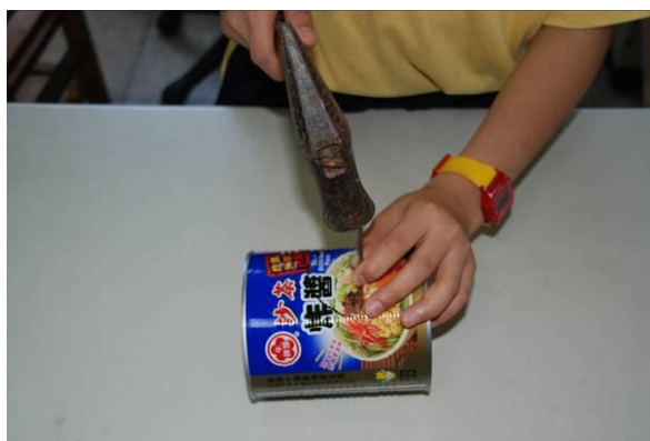
步驟二：鐵釘先釘出幾個洞穿
