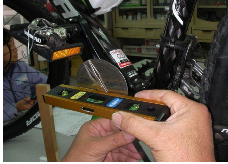
圖 18 利用水平儀與量角器測量曲柄角度
