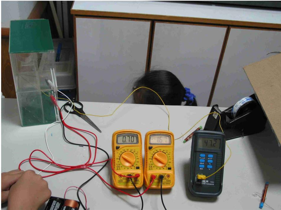
3.開始測量：換上不同數目的電池，測量電磁鐵的磁力、電流、電壓及溫度，因起初我們沒有天平砝碼可用，所以只用一些現成物品（3號電池、大鐵釘、小鐵釘）當作我們秤重的砝碼，之後我們有借到天平砝碼，我們仍沿用這些物品，只是測出它們個別的重量，將磁力轉成能吸起的重量。
