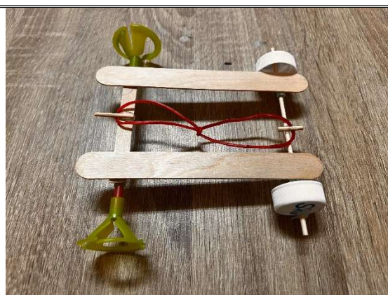
【圖四】加上互綁的橡皮筋做為動力系統
