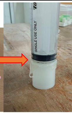
圖八:將外面熱熔膠去除，然後以膠帶纏繞固定，就完成一支底片盒空氣砲
