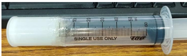
圖三：針筒容積：65ml(包括前端與拉到底端)
