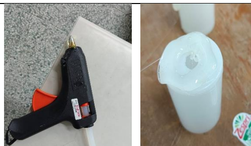
圖六：用熱溶膠將底片盒溶出稍微大一點的洞，並在底片盒上擠上一些熱溶膠
