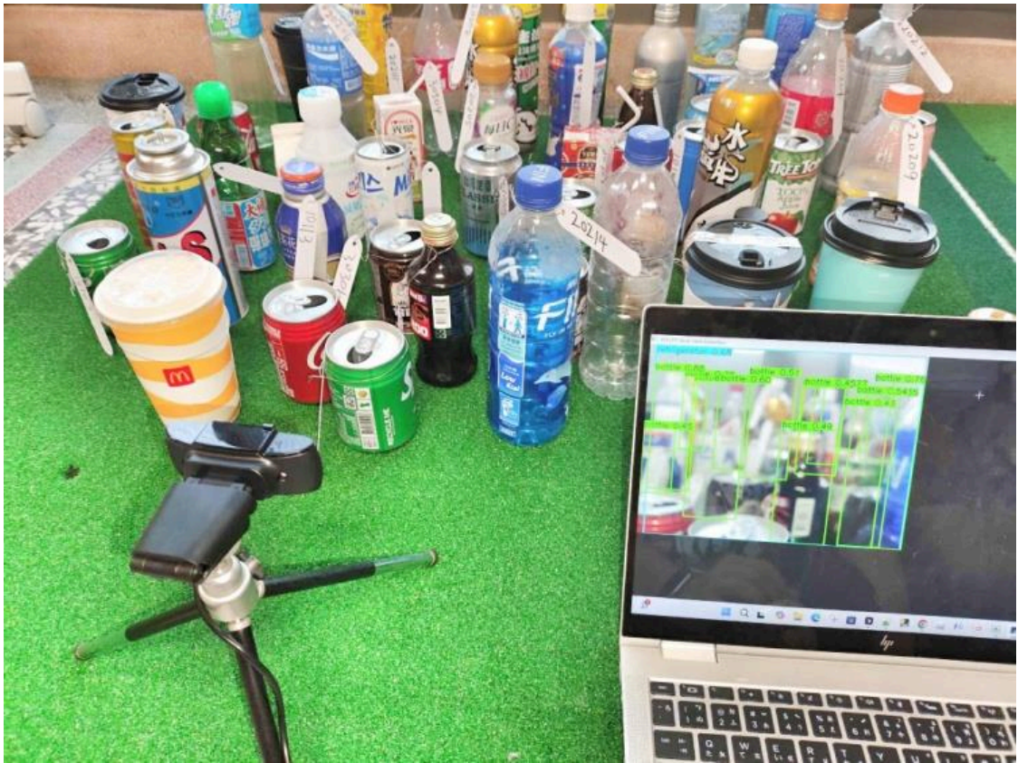
圖六、使用攝影機及時辨識與分類資源回收飲料瓶
