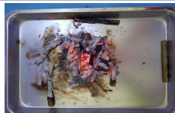
四邊形加鋪底層立體堆疊燒成碳化和灰燼，倒塌後散落邊緣的木材沒有燃燒
