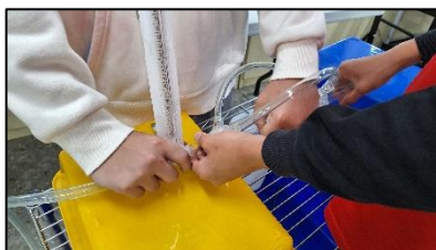
圖 7-8 連接二種口徑的壓克力管
