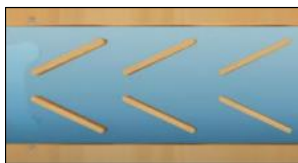
圖 3-1 「改變流體速度的通道－特斯拉閥」作品使用之特斯拉閥
