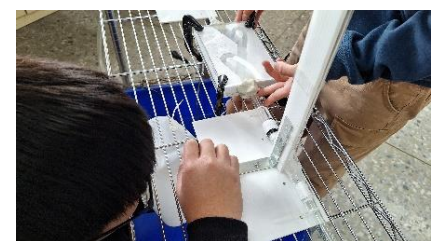
圖 7-14 使用油土密閉 特斯拉閥周圍
