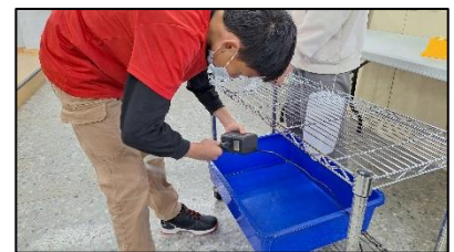
圖 7-13 連接馬達及水壓測量模組
