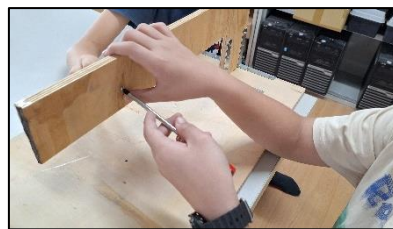
圖 7-6 將熱熔絲固定於底座及 支架之間
