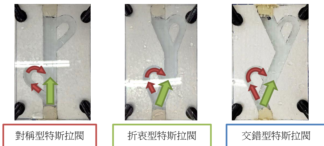
圖 8-3 不同主水道形狀之水流狀態示意圖
