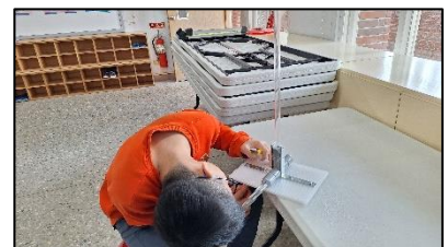
圖 7-10 於壓克力管上固定尺規
