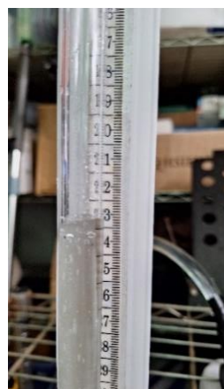
圖 3-3 本研究運用托里切利實驗原理設計之水壓測量模組
