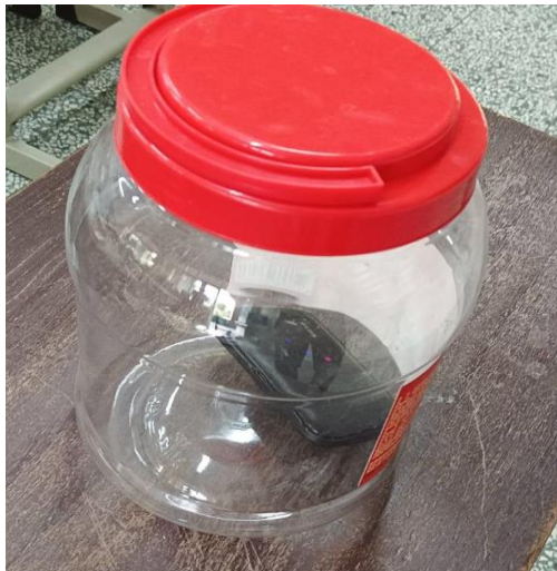
圖十七、將 D-Link 無線 wifi 分享器放入塑膠罐中
