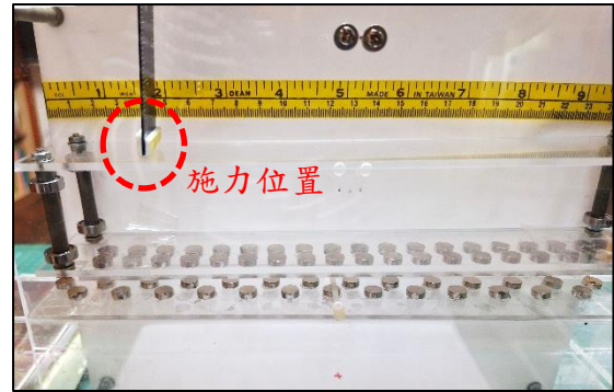
圖 8-22 使用直尺於平台不同處施壓測量其平衡能力
