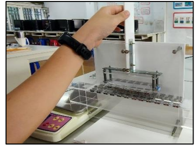
圖 8-1 將磁浮平台放入前後側板中，進行承載力測量
