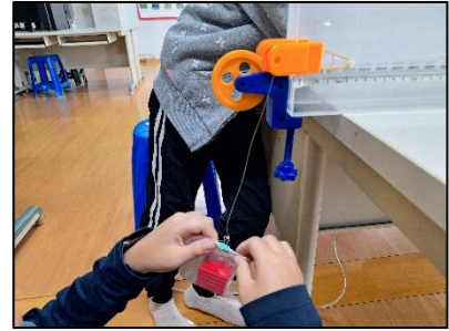
圖 7-13 將砝碼吊掛於尼龍繩上，以拉動磁浮平台
