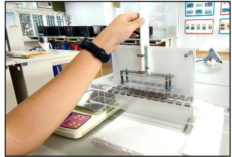
圖 7-18 使用 T 型架向下施力於磁浮平台
