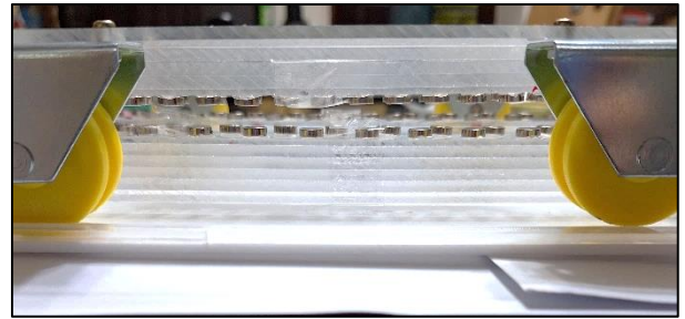
圖 8-35 使用八片墊片的輪車磁軌
