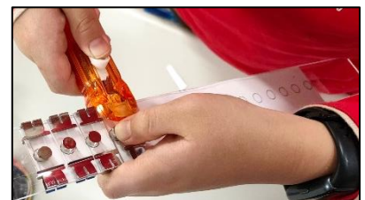
圖 7-5 使用夾子將磁鐵片固定 在磁浮平台上
