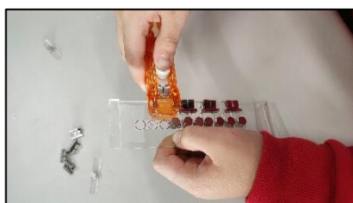
圖 7-7 將小磁鐵片固定在 上下磁鐵片上
