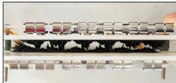
圖 8-6 上下間隙皆為 0.8 公分之鐵粉狀態
