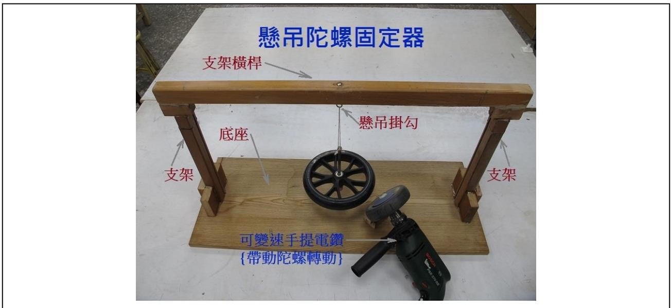
懸吊陀螺固定器（上圖）及其操作過程說明（下圖 1---8）
