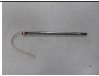
陀螺轉軸 (取自電風扇馬達軸心)
