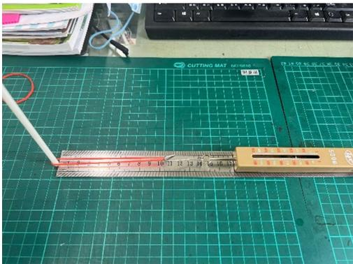
【圖三】利用彈簧秤尋找拉長量一致的橡皮筋
