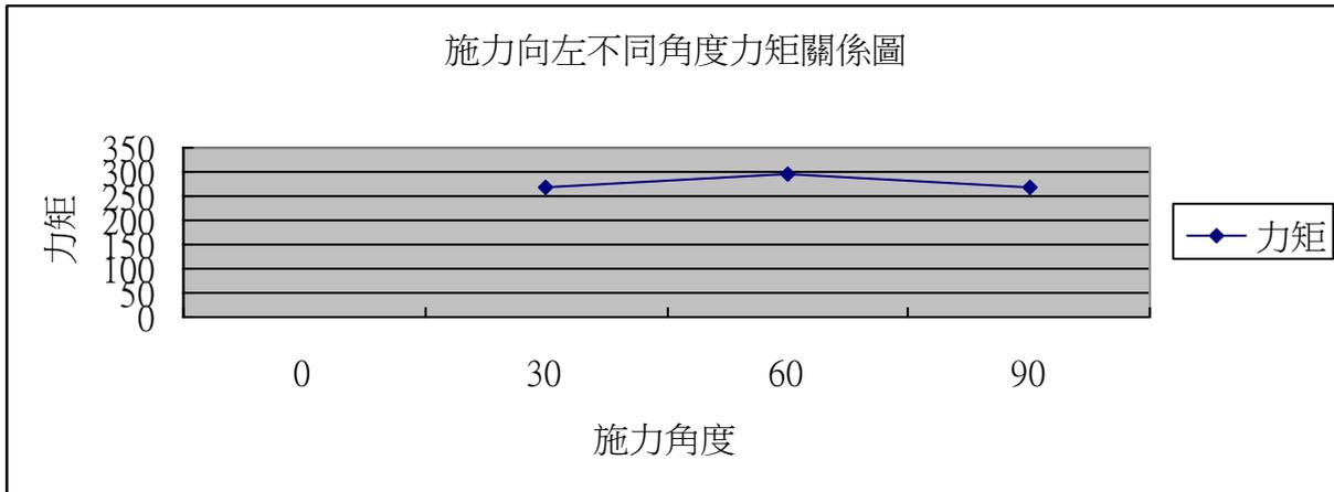
(四) 實驗二：在陷阱模型上刻劃出向右施力的三個角度，分別是 90 度、60 度、30 度，測量觸動 C 竹片時施力的大小。(0 度在實驗一已經做過，所以省略)
