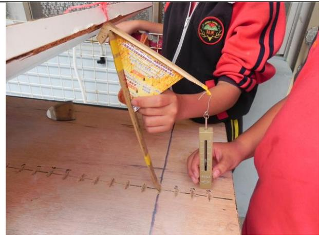
以 50 度夾角測量 B 竹片尾端的拉力。
