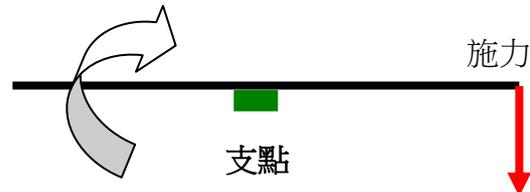
沒有壓石頭，尖端向下施力時，長竹片會形成一個輪軸，在原地旋轉而不會掉下來，這種情況會使陷阱變成失敗的陷阱。
