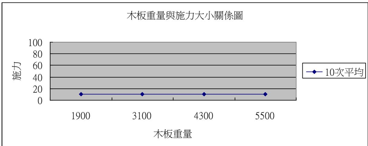
3、討論：本實驗看出這四種不同重量的木板，C 竹片被觸動掉落時的施力大約都是 10 公克重。研究四-(五)已經得知向左施力時 B 竹片尾端連接 C 竹片竹節的地方是「支點」，雖然木板重量增加，但是力量沿著 B 竹片作用在支點上，不影響 C 竹片的力矩。因此就算石板很重，老鼠還是可以輕易觸動陷阱。
