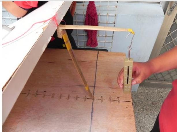
測量 B 竹片尾端的拉力。
