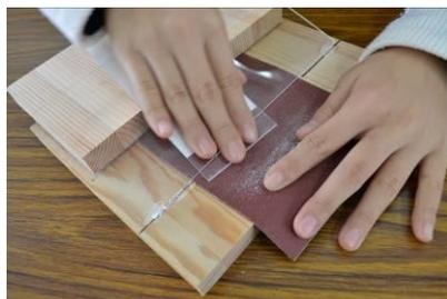
圖 6-17 使用斜角製作器磨邊
