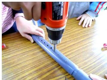
圖 6-14 在水管上穿出 10 個小洞
