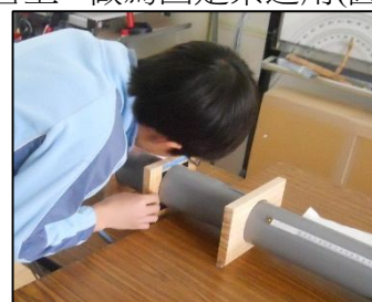
圖 6-8 將固定架套在外管上
