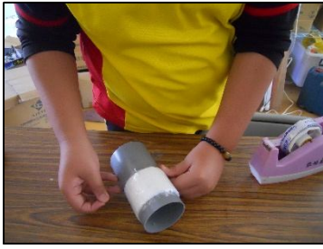
圖 6-9 不織布繞在光柵管外
