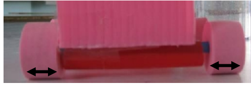
圖 4-26 車輪的寬度示意圖(左右各 1 個海綿輪)
