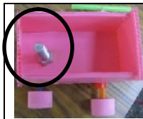
圖 4-13 甲：螺絲放在車廂的前面(重心在前)
