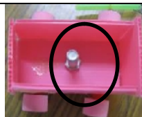
圖 4-14 乙：螺絲放在車廂的中間(重心在中間)
