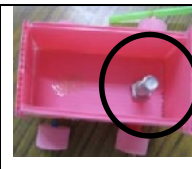
圖 4-15 丙：螺絲放在車廂的後面(重心在後面)
