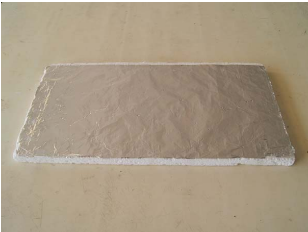
圖 6-2 DIY 製作鋁箔紙反射板
