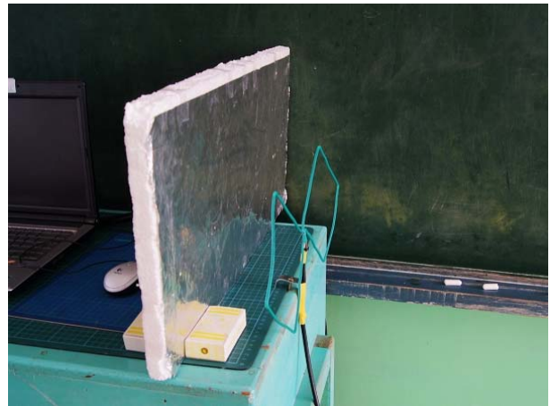
圖 6-3 鋁箔紙反射板和天線
