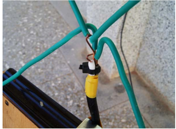
圖 2-3 DIY 天線連結至同一條同軸電纜
