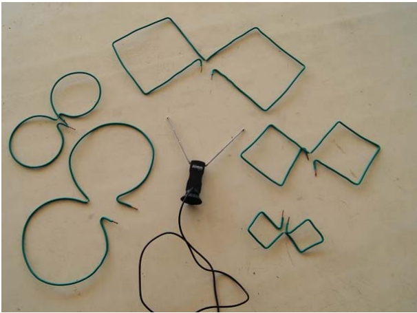
圖 5-2 使用實驗三與實驗四收訊良好的天線 進行室內實驗
