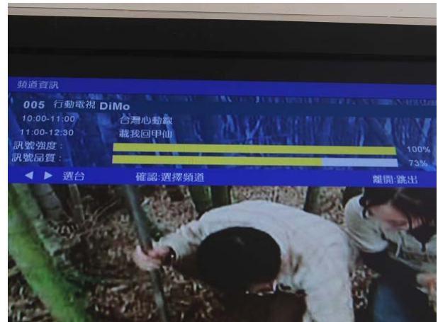
圖 7-4 數位節目訊號接收正常，畫面清晰穩定
